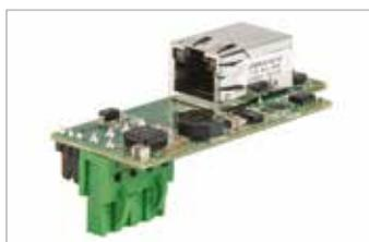
IP-Doorway è un'interfaccia in grado di rendere "IP-ready" tutti i rivelatori digitali CIAS. Mediante IP-Doorway, la barriera o il sensore nel quale viene installato diventa a tutti gli effetti un "rivelatore IP nativo".
